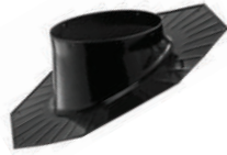
Scossalina inclinata per tetti inclinati 22-27° da inserire a livello della barriera vapore o guaina.
